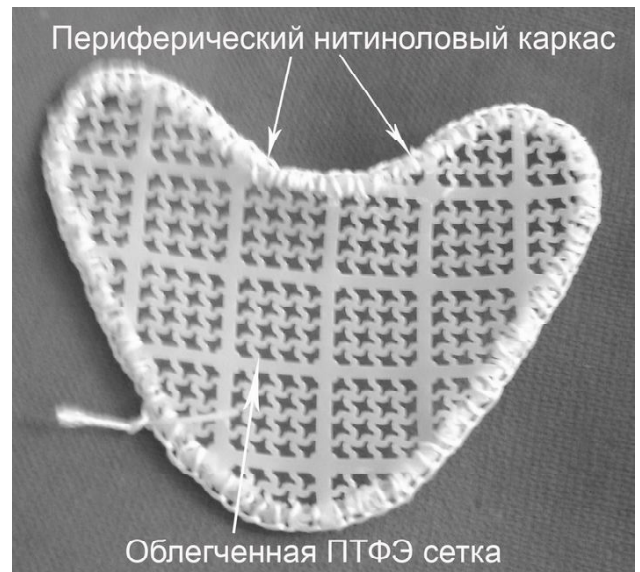
Рис. 1. Полегшений ПТФЕ трансплантат з периферичним нітиноловим каркасом.
